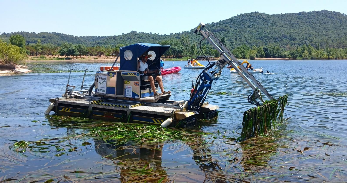
Faucardage mécanique à la Base de Plein Air Destination Salagou ©CCC
